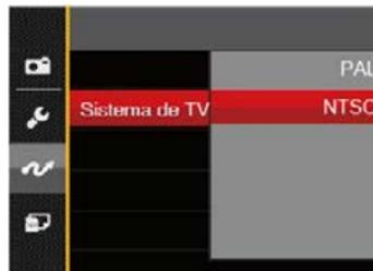
La señal de salida de video puede alternarse entre NTSC o PAL para adaptarse a los diferentes estándares regionales. La configuración adecuada variará de una región a otra.
